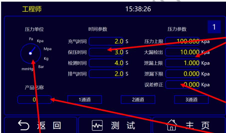
填入相关的时间和压力参数。“压力下限”的值设置比大漏产品的测试压力值稍大，用以检出不漏的产品。“泄漏上限”值用来界别良与不良品。
